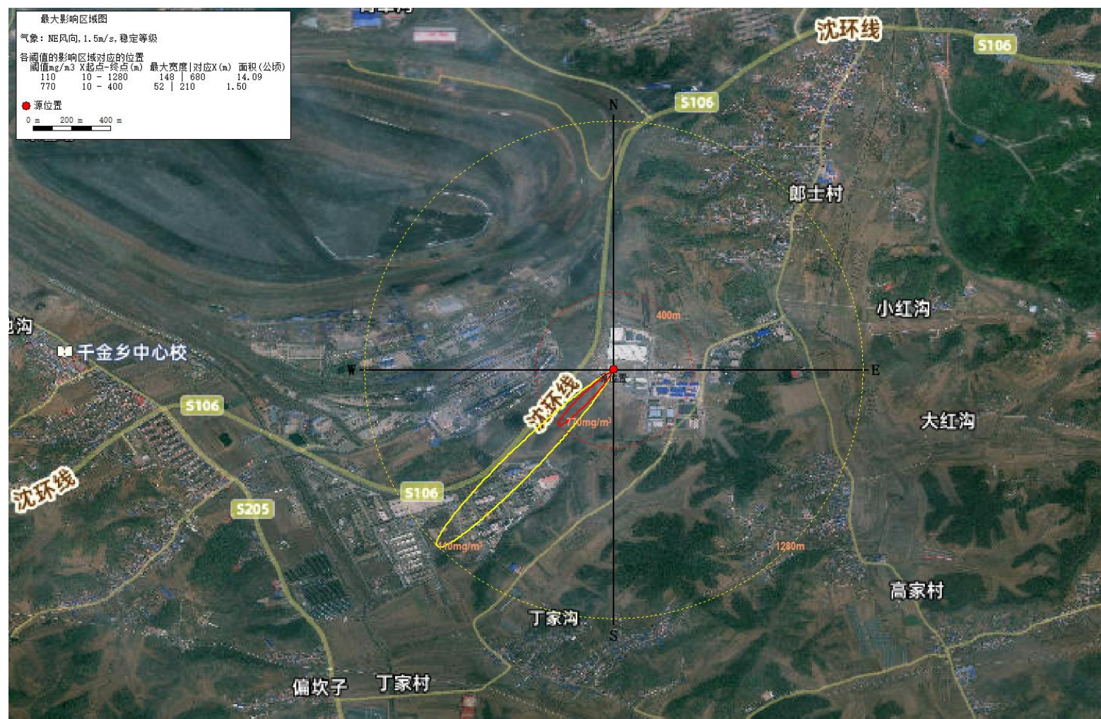
图 6-2 最不利气象条件下, 下风向不同距离有毒有害物质最大浓度分布示意图
