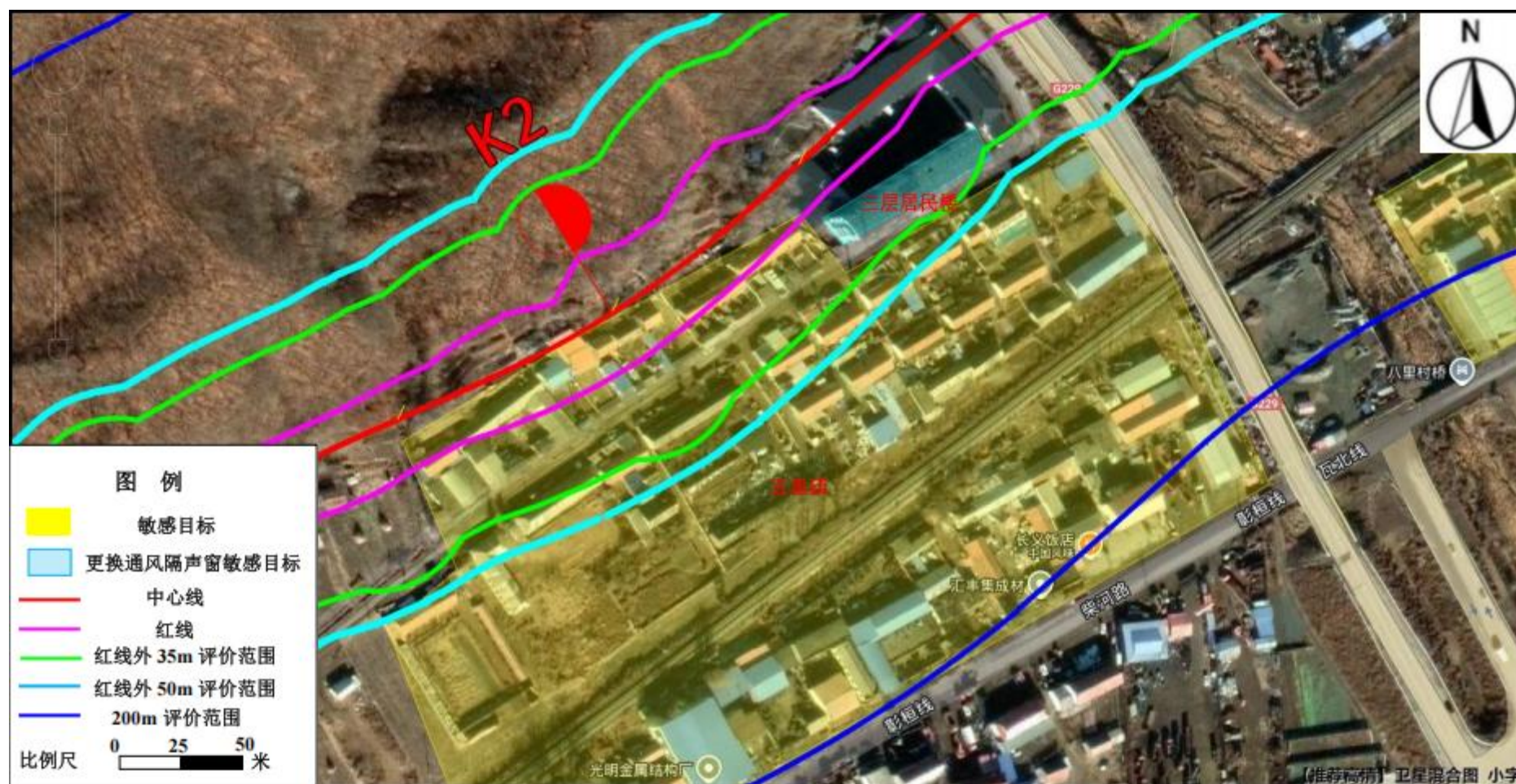
图6.2-2 交通噪声防治措施示意图（五里庙三层居民楼更换通风隔声窗处）
