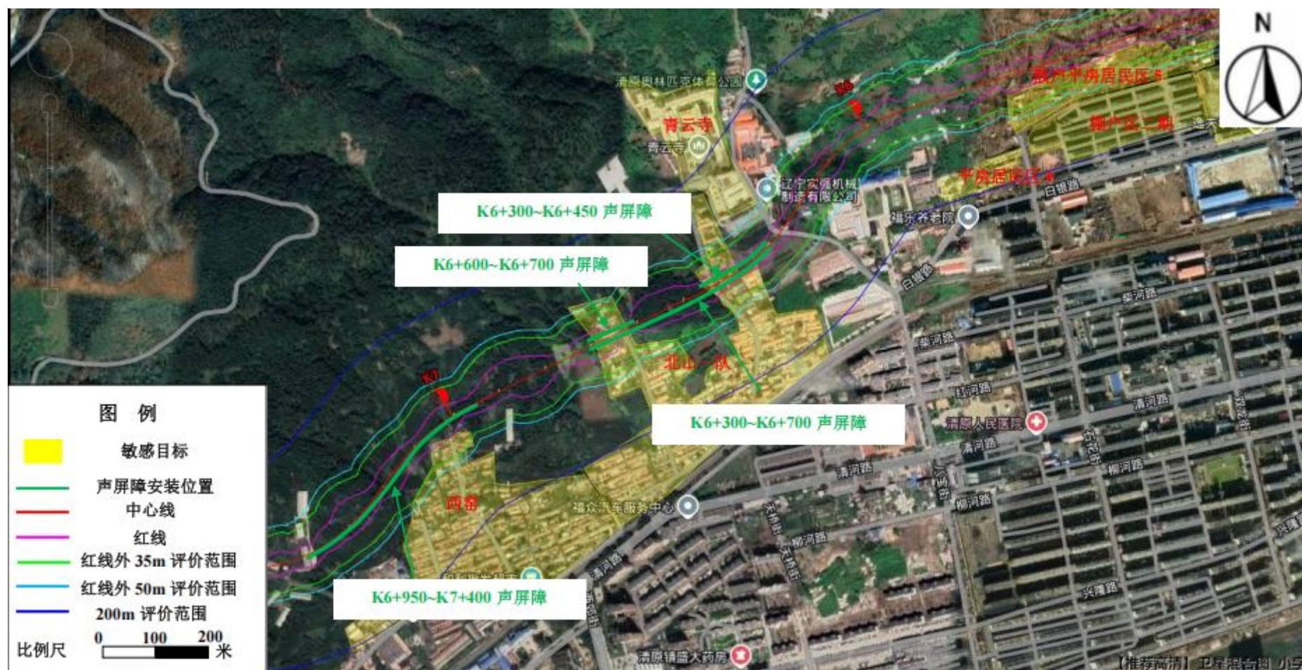
图6.2-4 交通噪声防治措施示意图（安装声屏障处）
