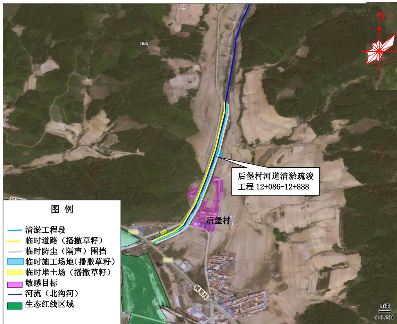
附图 6-6 施工期总平面布置图 (后堡村河道清淤疏浚工程)
