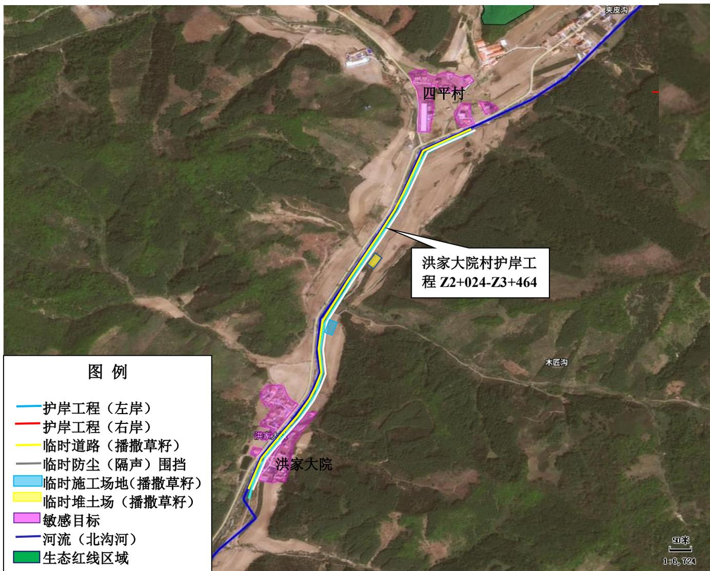
附图 6-2 施工期总平面布置图（洪家大院村护岸工程）
