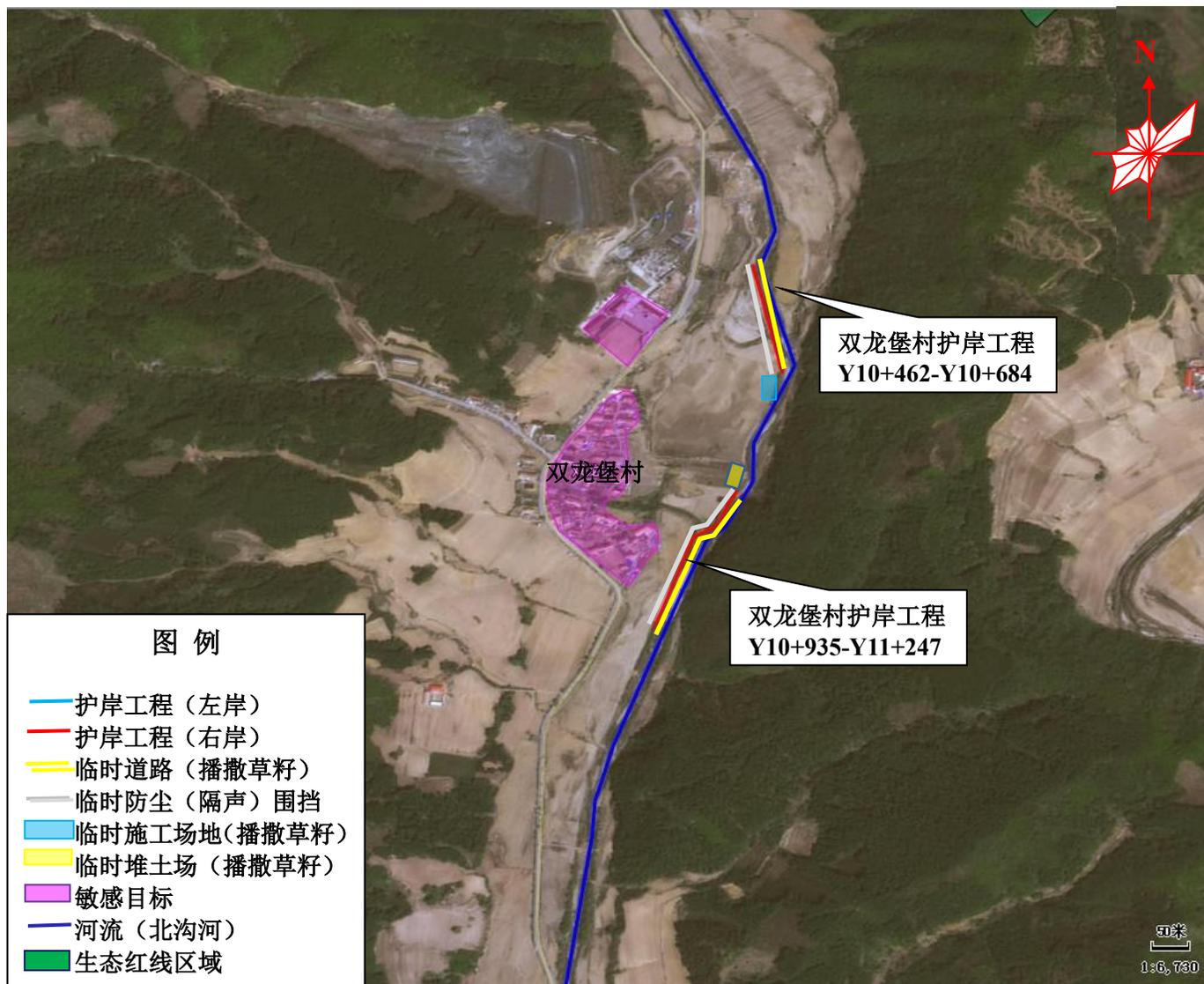
附图 6-5 施工期总平面布置图（双龙堡村护岸工程）
