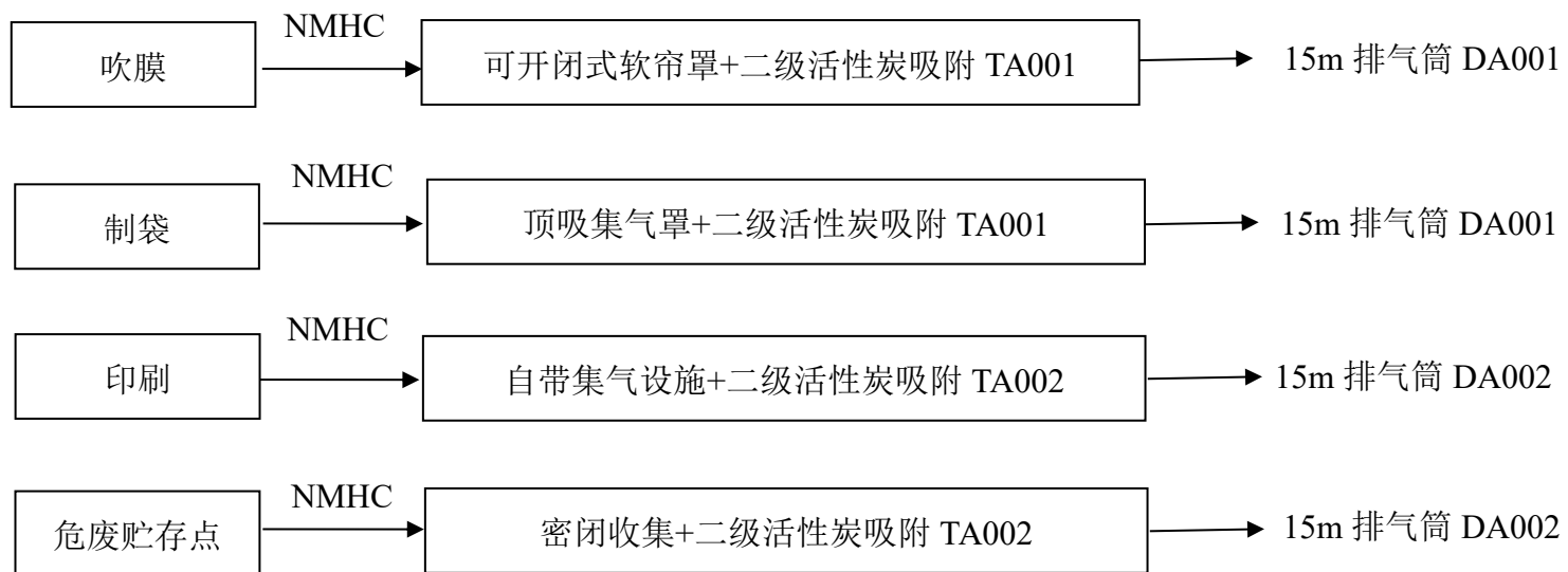
图 4-1 本项目废气收集、处理示意图
