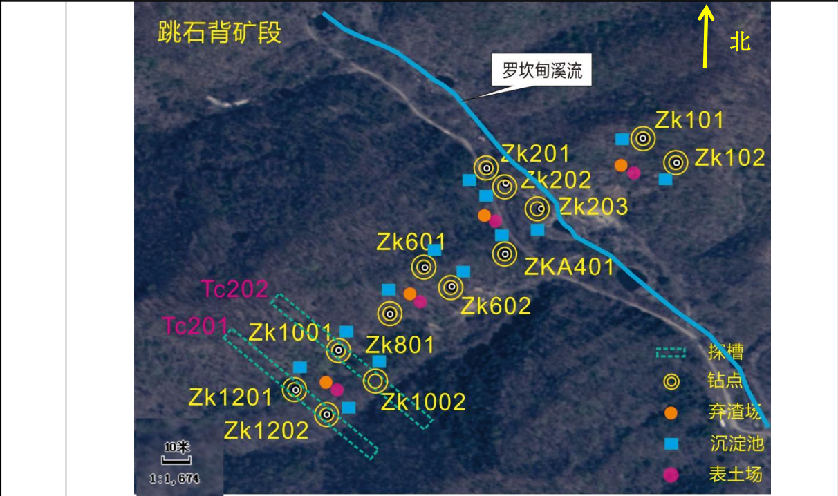
图 2-5 跳石背沟矿段施工平面布置示意图
