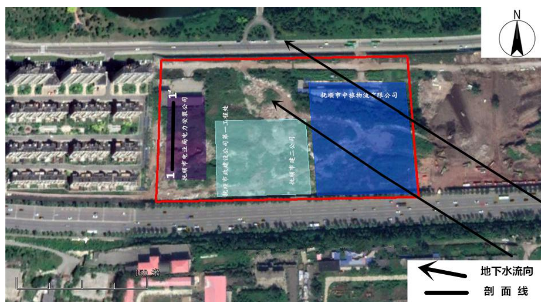
图 2-5 地块地下水流向及剖面线标注图
