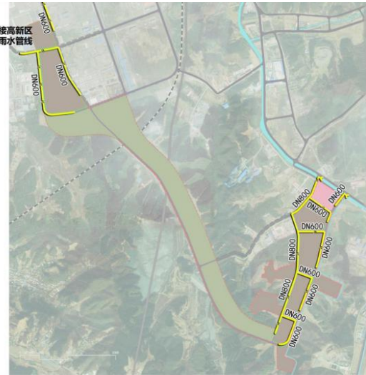
本项目所在园区雨水管网
